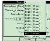
2. Parcourir les options du transducteur en sélectionnant les options appropriées à partir du menu déroulant, ou bien taper manuellement la sélection requise (si une case est grisée, vous n'avez pas à entrer de sélection pour ce paramétrage). La température de calage est typiquement à mi-chemin entre la température de la canalisation et celle de l'air.
