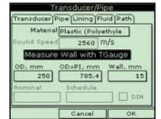
3. Une fois que vous complétez l'onglet du transducteur, sélectionner le haut de la page et appuyer sur les flèches pour éclairer l'onglet du Menu Canalisation. Appuyer sur [ENTER] pour ouvrir le Menu Canalisation. Parcourir les options comme indiqué à l'étape 2.
