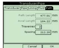
4. Répéter l'étape 3 pour les 3 autres onglets restants, Fluid, Revêtement et Circuit (deux traverses sont courantes pour une facilité d'installation et de précision – Plus d'information dans la section 2).
