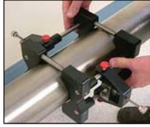
**Remarque:** chaque moitié du dispositif de fixation comporte une échelle de mesure. Faites en sorte que la règle se trouve sur le même côté avec le zéro à la même origine.
